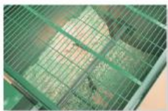
Buncăr pt. rumeguș cu grătar de cernut, amestecător și sneck pt. dozarea rumegușului în camera de uscare-ardere
