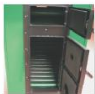
Ușile de la focar sunt căptușite cu material refractar și sunt dotate cu vizor
