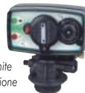
Serie **FL 5600 SXT** con valvola Fleck elettronica a tempo o volume e volume/tempo. Display LCD, elettronica semplificata, consente di determinare i giorni e gli orari di rigenerazione, variare la durata dei cicli. Rigenerazione forzata ogni 4 gg a norma del D.M. 443/90.
