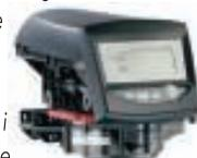
Serie **FL5600** con valvola Fleck elettromeccanica a tempo (serie T, max una rigeneraz. al giorno) o volume/tempo (serie V con rigeneraz. alle 2 di notte). Estremamente facile da programmare tramite i 2 dischi di programmazione. Durata rigenerazione fissa 120'.
