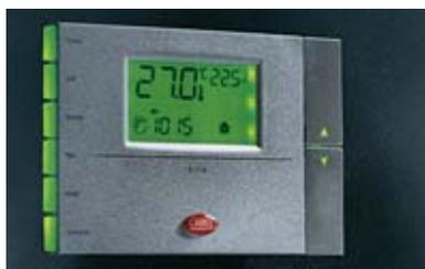
Terminale multiprocessore elettronico con display a cristalli liquidi per il comando e il controllo dell'apparecchio. **Fornito di serie.**
