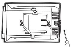
5. Fixati carcasa pe perete cu ajutorul suruburilor
