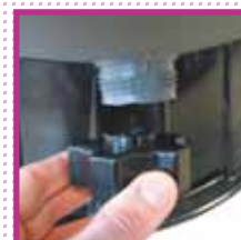
Drain avec son bouchon servant d'outil de démontage. Drain with its plug which serves as dismantling tool.
